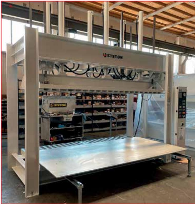
**Steton Presse mit mobiler Pressfläche PF 90 A 3013**
