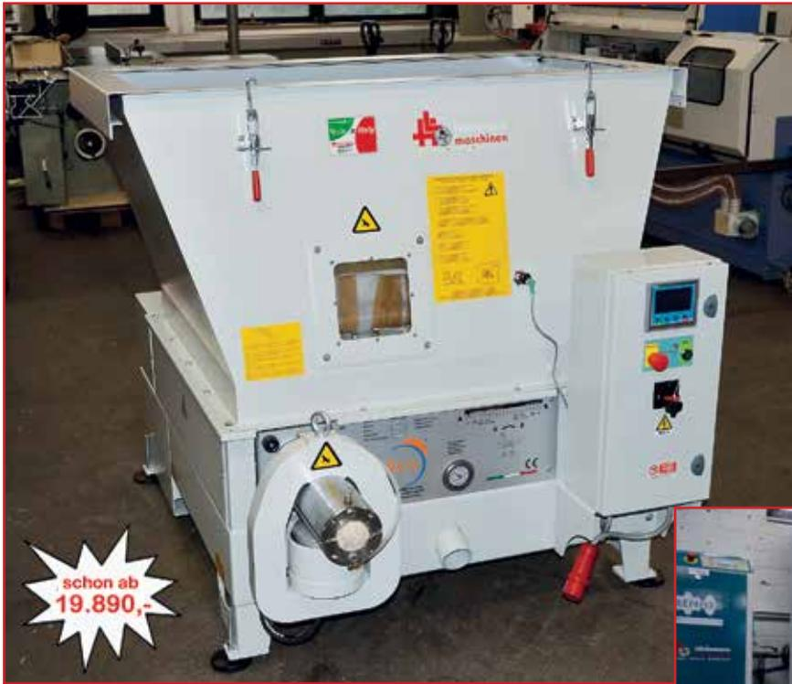
**PRODECO Brikettpresse E 60 Nano Super**, Neumaschine, CE-Zeichen, mit Spänebehälter, auch unterbaubar für Absauganlagen, hydraulisches System 7,5kW, Leistung 40-100kg/h, Druckkraft ca. 900kg/cm<sup>2</sup>, Brikett Ø= 60mm, Steuerpult mit SPS Steuerung und digitalem TouchScreen Display, Serviceluke, Höhe 1.510mm, Länge 1.850mm, Tiefe 1.170mm, Gewicht 770kg, Bild oben links
