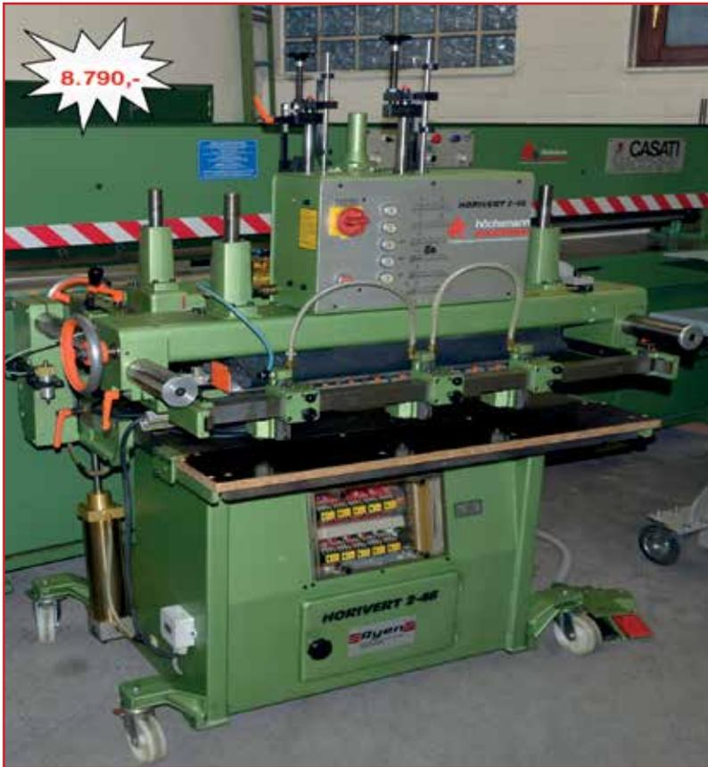
**Ayen Lochreihenbohrautomat Horivert 2-46,** die Maschine ist in Kompaktbauweise so aufgebaut, dass die stabile Grauguss-Tischplatte, die Schwenkeinrichtung sowie die Bohrbalkengruppe eine verwindungsfreie, hochpräzise Einheit bilden. Die komplette Arbeitseinheit ist auf einem stabilen Maschinengestell montiert. Jeder der beiden Bohrbalken hat 23 Bohrspindeln mit 32 mm Spindelachsabstand.
