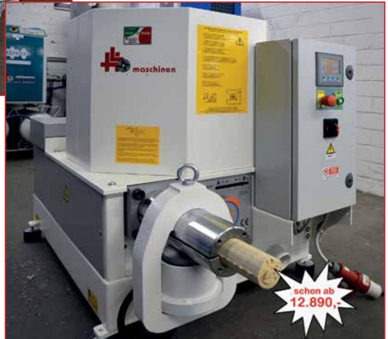
**PRODECO Brikettpresse E 60 Nano**, vorführbereite Ausstellungsmaschine, CE-Zeichen, mit Spänebehälter, hydraulisches System 5,5kW, Brikett Ø= 60mm, Leistung 15-70kg/h, Druckkraft ca. 900kg/cm<sup>2</sup>, Steuerpult mit SPS Steuerung und digitalem Touch Screen Display, Serviceluke, achteckiger Behälter Ø 750mm, Maße: Höhe 1.065mm, Länge 1.500mm, Tiefe 900mm, Gewicht 450kg, Bild unten
